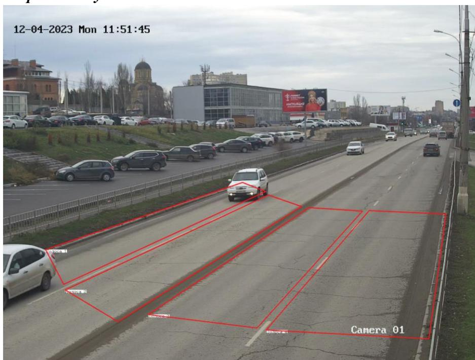
3. Минизоны должны иметь такую же ширину, что и полосы на которых они находятся, то есть быть нанесены вплотную к полосе.
