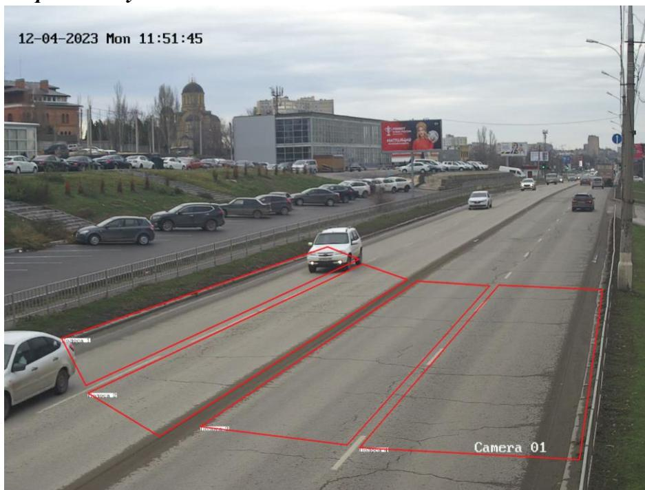
3. Минизоны должны иметь такую же ширину, что и полосы на которых они находятся, то есть быть нанесены вплотную к полосе.
